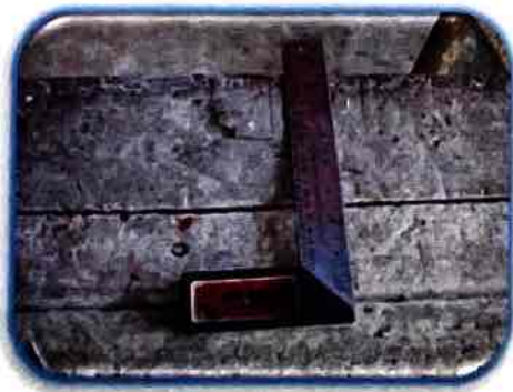
สำหรับใช้วัดความยาว ความกว้างของไม้ที่ใช้ประกอบเป็นโครงสร้างตัวปราสาทศพ
